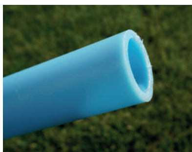
Rura przed fazowaniem A pipe before chamfering
