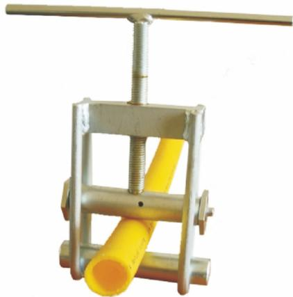
Zaciskacz do rur PE służy do zamykania przepływu gazu lub wody w uszkodzonym rurociągu. Zaciskacz posiada tarczę dystansową, która zapobiega uszkodzeniu rury poprzez nadmierne jej ściśnięcie.
