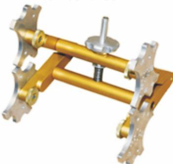
Zacisk ten ułatwia prawidłowe zamocowanie elektrozłączki na rurze zapewniając jej całkowite unieruchomienie podczas całego cyklu zgrzewania oraz fazie studzenia. Elektrozłączka oraz końce rur pozostają idealnie wycentrowane co ma duże znaczenie dla prawidłowego wykonania zgrzewu. Zakres średnic: 16-63 mm.
